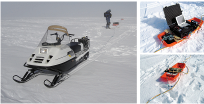
Figuur 1: Sneeuwscooter met GPR systeem. De transmitter van het radarsignaal bevindt zich op de achterste slede, het signaal wordt ontvangen en opgeslagen op een computer op de voorste slede. De antennes bevinden zich voor, achter en tussen de sledes.
