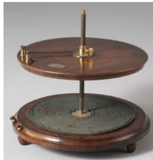
Figuur 1 Een set Riess-spoelen: twee boven elkaar geplaatste spiraalvormige spoelen. Via inductie maakte een stroom in de ene spiraal een effect in de andere spiraal. Bron: http://www.teylersmuseum.nl
