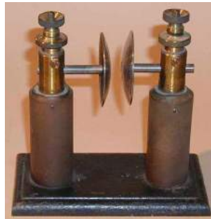
Figuur 4 Vonkbrug. Bij voldoende hoog spanningsverschil tussen de twee polen treedt elektrische doorslag op. http://www.scienceantiques.com
